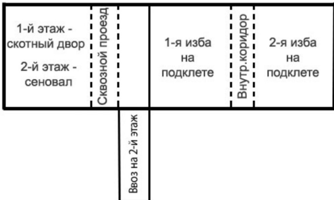
Рис. 12. План (вид сверху) крестьянского подворья Ивановых («Воронцовых») в деревне Каменке. Общая длина строения – 25 м, ширина – 8 м (без учёта выступающего ввоза на 2-ой этаж).
